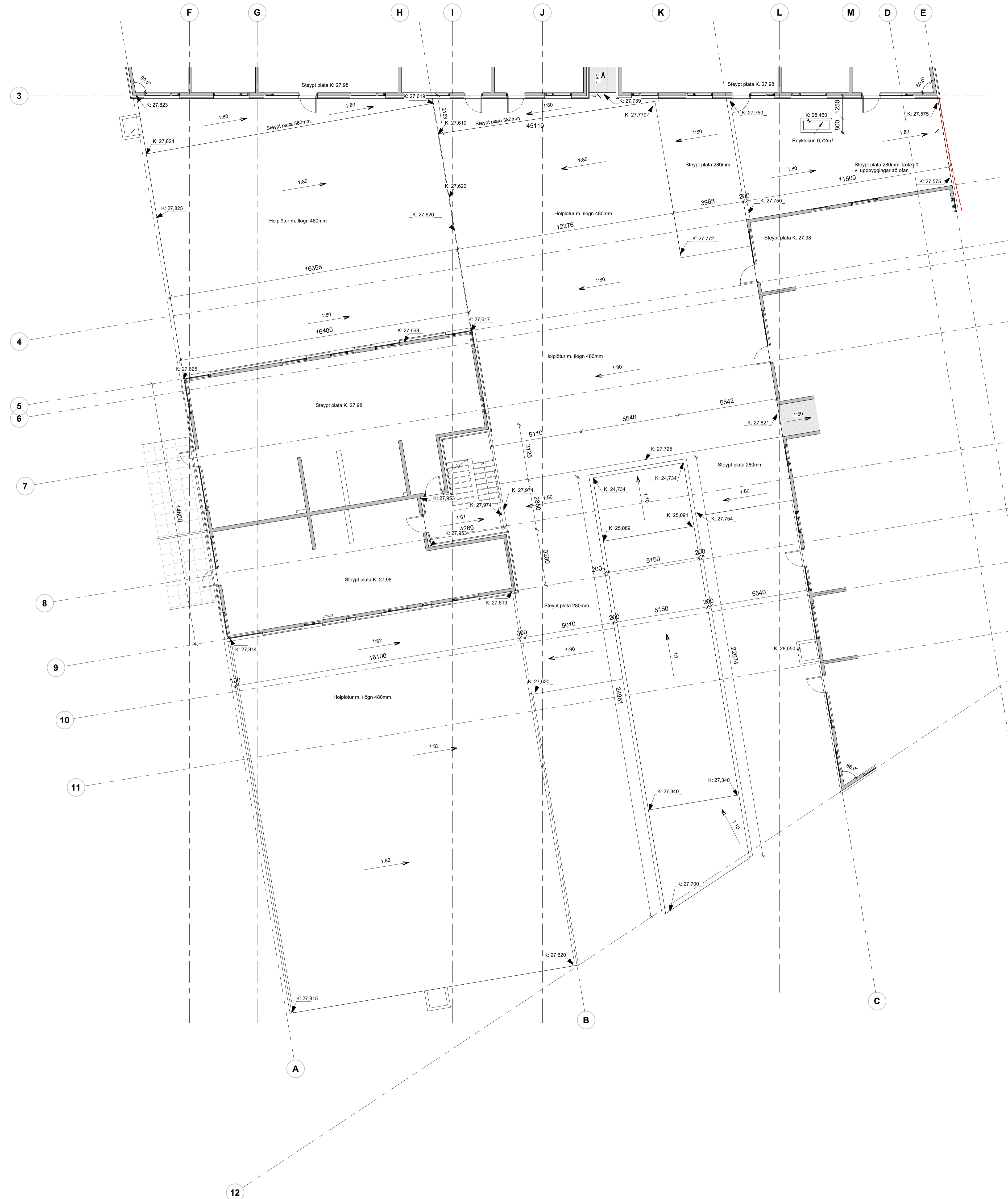
01-Hæð 1 - Steyputeikningar Hallaplan plötu yfir bilakj. 1:100
